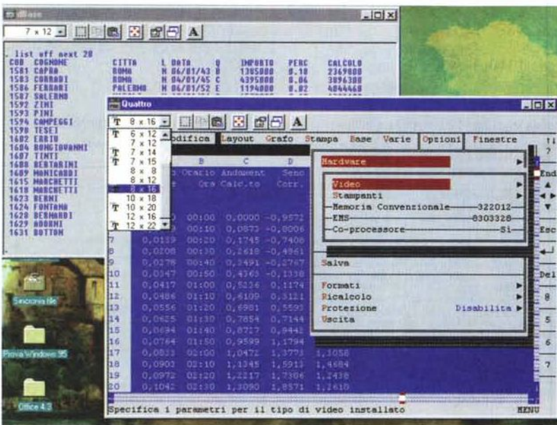
Figura 11 - Windows 95 - Applicazioni DOS in finestra. A seconda dei casi, Windows 95 mette a disposizione delle applicazioni DOS tutto il video, oppure una finestra grafica che simula la videata alfanumerica, permettendo anche di scegliere il tipo di carattere. Mette, se necessario, a disposizione il massimo di memoria convenzionale e/o espansa e/o estesa, gestisce il mouse per conto dell'applicazione DOS, ecc. In situazioni estreme Windows 95 è disposto a mettersi da parte per far ripartire il sistema in una modalità MS DOS «pura».
